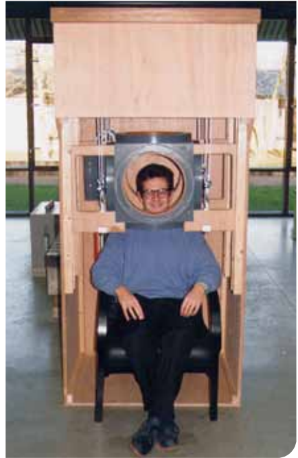
Dispositif expérimental pour l'analyse des effets des champs magnétiques (50 Hz) sur le corps.
