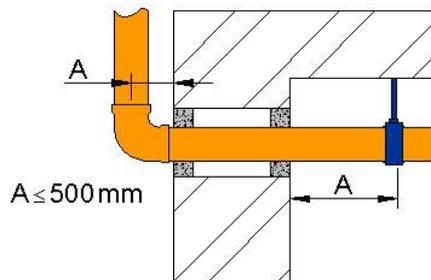
1.7 Solution type B - traversée simple au moyen d'un fourreau
